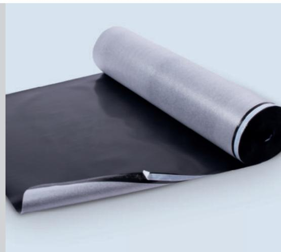
Die Gefitas® PE Dampfsperre 1/400 besteht aus einem hochwertigen, geschlossenzelligen 1 mm starken PE-Schaum und einer 400 µm PE-Laminatschicht. Bei rauem Untergrund ist daher ein Vlies als zusätzliche Lage nicht mehr notwendig. Der integrierte Dichtrand ermöglicht eine einfache Verklebung der Bahnen untereinander. Mit dem dazu kompatiblen Gefitas®-Zubehör wird für Luftdichtigkeit gemäß den Anforderungen an die dampf- und luftdichten Anschlüsse gesorgt.
