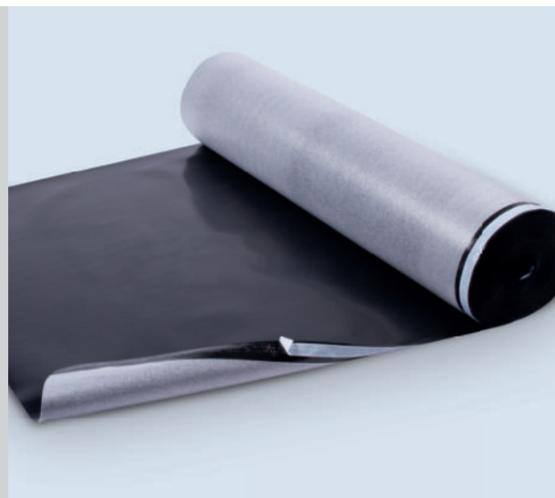
Die Gefitas® PE Dampfsperre 1/250 besteht aus einem hochwertigen, geschlossenzelligen 1 mm starken PE-Schaum und einer 250 µm PE-Laminatschicht. Bei rauem Untergrund ist daher ein Vlies als zusätzliche Lage nicht mehr notwendig. Der integrierte Dichtrand ermöglicht eine einfache Verklebung der Bahnen untereinander. Mit dem dazu kompatiblen Gefitas®-Zubehör wird für Luftdichtigkeit gemäß den Anforderungen an die dampf- und luftdichten Anschlüsse gesorgt.
